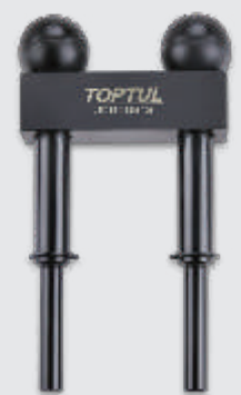
Localizando furos nas engrenagens da árvore de cames
