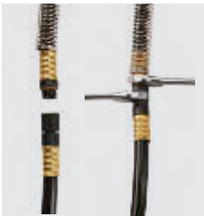
Desmontar e substituir a mangueira de ar de conexão
