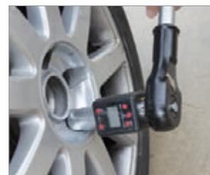
**Medidas**Rango de Torque: 100 - 500Nm.
