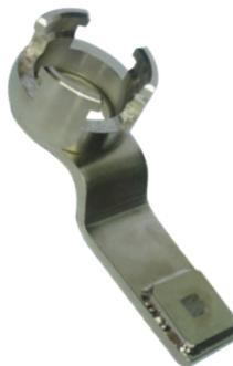
Permite sujetar el cigüeñal mientras aflojan el tornillo central de la polea. Con cuadrado de 1/2" para permitir usar un maneral para aplicar más fuerza.
