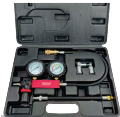
Diseñado para detectar una variedad de fallos comunes del motor tales como aros de pistón desgastados, válvulas desgastadas, fisuras en culata y juntas de culata sopladras.
