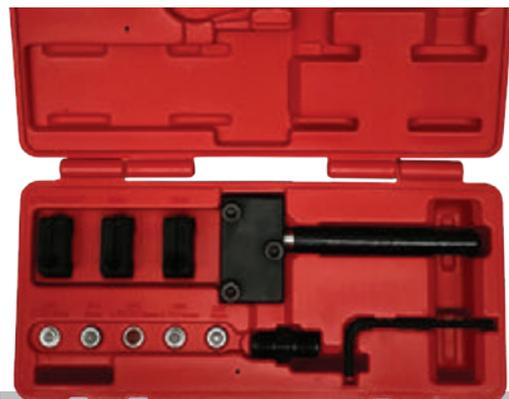
Conjunto de útiles necesarios para realizar las operaciones de extracción y otras relacionadas con los collarines de los tubos de frenos.
