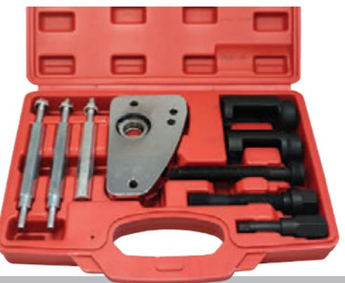
Diseñada para extraer inyectores sin la necesidad de quitar la cabeza del cilindro en vehículos con motores PSA 2.0Hdi (DW10 y DW12).
