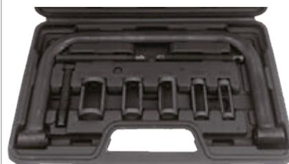
5 Adaptadores que permiten adaptar la herramienta a los muelles de válvula correctamente y realizar la compresión fácil y segura.
