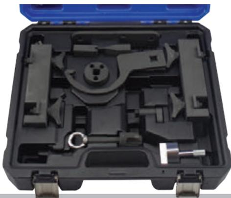
Este conjunto contiene las herramientas necesarias para la sincronización correcta de los motores gasolina 3.0 y 5.0.
