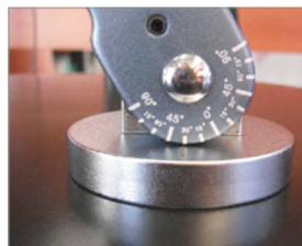
Cuando se reemplazan los amortiguadores, es necesario proceder a la regulación de la caída. Este útil evita tener que realizar el alineado.
