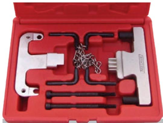
Este kit cubre una amplia gama de motores Mercedes de diésel y gasolina desde 1984. Contiene dos modelos de bloqueador de volante de motor y pasadores de bloqueo de árbol de levas.
