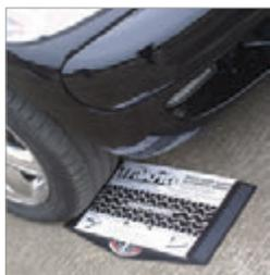
Trakrite se utiliza para realizar una sencilla y rápida comprobación de la alineación de las ruedas de un vehículo (divergencia o convergencia).
