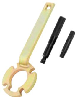
Este conjunto contiene la llave para sujetar cigüeñal necesaria para permitir el cambio de la correa de distribución. Adicionalmente lleva los pasadores de bloqueo de árbol de levas y cigüeñal esenciales para desmontar los piñones de los ejes de equilibrio.
