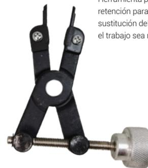
Herramienta para sujetar el anillo de retención para facilitar la extracción y sustitución del cilindro haciendo que el trabajo sea más fácil y rápido
