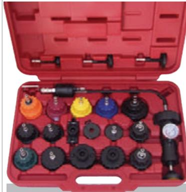
Permite comprobar los circuitos de refrigeración en la mayoría de los vehículos ya que consta de 19 adaptadores y una bomba de presión.
