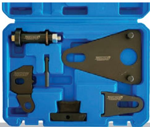
Conjunto de herramientas esenciales para el cambio de cadena de distribución de una serie de motores de gasolina 1.4, 1.6, 1.8, 2.0, 2.5 y 3.5. También es necesario para bloquear el volante de motor en los últimos motores diésel, 2.0 y 2.3 DCI.
