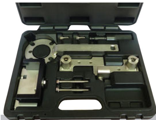
Este kit contiene las herramientas especiales para alinear los arboles de levas y cigüeñal durante la reparación de la unidad de válvulas variables y el desmontaje e instalación de los arboles de levas. También contiene la llave 9569 para sujetar la polea de cigüeñal.
