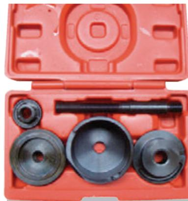
Herramienta para la extracción e instalación del silentblock trasero de la horquilla delantera.
