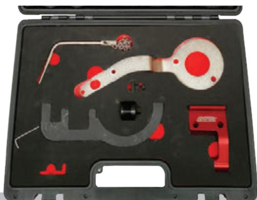
Este conjunto contiene las herramientas necesarias para mantener el motor en la posición correcta para reemplazar la cadena de distribución de los últimos motores diésel BMW 1.5 (B37) y 2.0 (B47) a partir de 2014.
