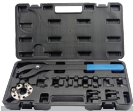
Conjunto completo de herramientas para sujetar poleas y piñones de árbol de levas, cigüeñal, bomba de aceite y bomba de agua. Permite bloquear y sujetar poleas para facilitar aflojar y apretar los tornillos de fijación. Herramienta esencial con cobertura e toda la gama de motores del Grupo VAG.
