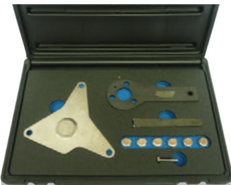
Conjunto de herramientas para el reglaje del motor 1.4 Multiair de Fiat.
