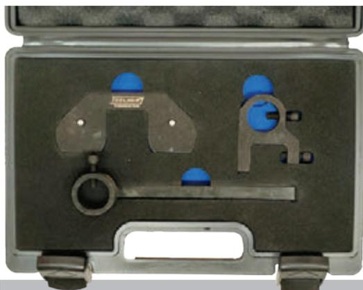
Herramientas especiales para bloquear y alinear los ejes de equilibrio del motor 2.2 diesel utilizado en vehículos Ford, PSA, Land Rover y Range Rover.
