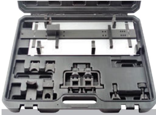
Herramienta especial que permite montar los árboles de levas dentro de su marco de retención para poder montarlos correctamente.
