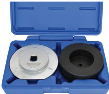
Este conjunto de herramientas está diseñado para asistir en el cambio del retén delantero del cigüeñal de los motores Ford Duratorq 2.0, 2.2, 2.4 y 3.2 utilizados en vehículos, Ford, Jaguar y Land Rover. Contiene un extractor/instalador para la tapa del retén y un alineador de la tapa delantera del motor.
