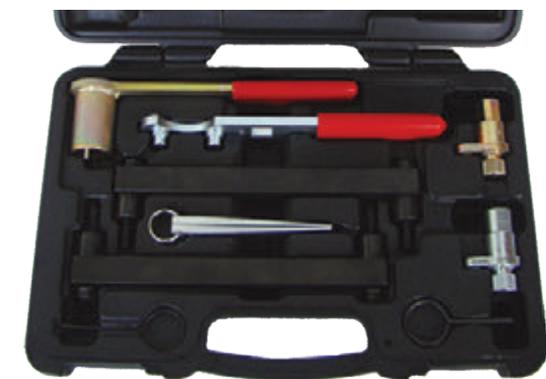
Kit de reglaje para motores una amplia gama de motores de gasolina de las marcas Land Rover y Jaguar.
