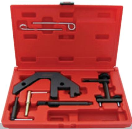
Este conjunto permite la sincronización correcta en los motores diesel BMW 2.0D, 2.5D y 3.0D con tipo de motor M47 y M57.
