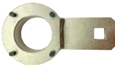
Llave para sujetar el cigüeñal para facilitar aflojar y apretar el tornillo de fijación.
