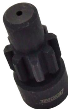
Permite girar manualmente la posición del cigüeñal en motores Scania a partir de 1996.
