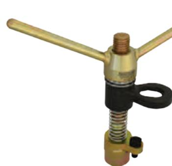
Para el montaje y desmontaje de los muelles de válvula con la culata montada o desmontada. Proporciona un gran ahorro de tiempo al permitir reparar muelles de válvula y juntas de vástago de válvula sin necesidad de desmontar la culata. Montaje mediante la guía del inyector-bomba.
