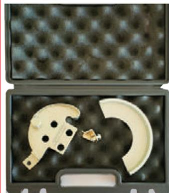
Juego de dos herramienta que facilita la instalación de la correa auxiliar cuando el ancho de la polea del cigüeñal restringe el acceso. Una pieza se pone en la polea de cigüeñal y la otra en la polea de la bomba de agua y usando un vaso de 17mm se rota para colocar la correa en las poleas.
