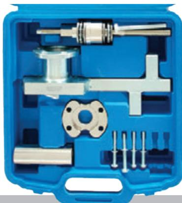
Kit de herramientas para sujetar la polea de cigüeñal para facilitar el apriete y aflojamiento del tornillo central y también para permitir quitar la polea.
