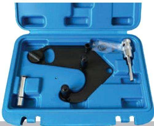
Este kit contiene el alineador de árbol de levas y el pasador de cigüeñal específico para el motor 3.0DCi de Renault utilizados en modelos Renault y Nissan.
