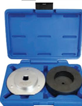
Este conjunto de herramientas está diseñado para asistir en el cambio del retén delantero del cigüeñal de los motores Ford Duratorq 2.0, 2.2, 2.4 y 3.2 utilizados en vehículos, Ford, Jaguar y Land Rover. Contiene un extractor/instalador para la tapa del retén y un alineador de la tapa delantera del motor.
