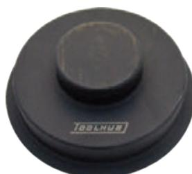
Útil que permite instalar el retén trasero del cigueñal con presión uniforme para evitar dañar el retén.
