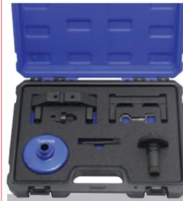
Kit de reglaje para el motor 4.0 gasolina del Grupo Vag utilizado en modelos de la marca Audi.
