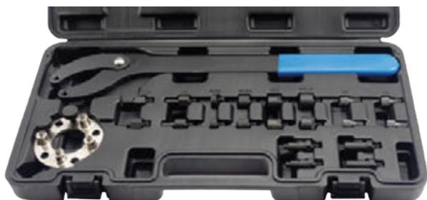
Conjunto completo de herramientas para sujetar poleas y piñones de árbol de levas, cigüeñal, bomba de aceite y bomba de agua. Permite bloquear y sujetar poleas para facilitar aflojar y apretar los tornillos de fijación. Herramienta esencial con cobertura en toda la gama de motores del Grupo VAG.
