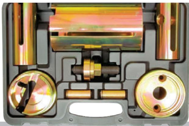
Conjunto de herramientas que permite extraer e instalar el silentblock del brazo de suspensión trasero sin la necesidad de desmontar el brazo.
