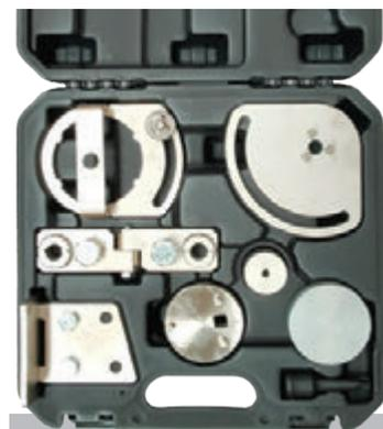
Conjunto de reglaje para los motores gasolina Volvo de 6 cilindros 3.0 y 3.2 utilizado en vehículos Volvo y también el Land Rover Freelander 2.
