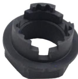
Herramienta especial utilizada para la extracción e instalación del ajustador del árbol de levas
