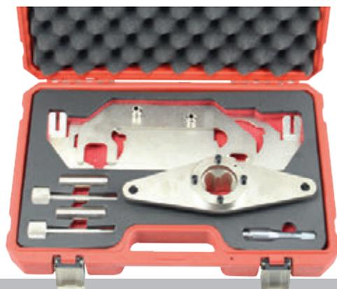
Conjunto de reglaje para el motor nuevo Ingenium de gasolina con 4 cilindros de Land Rover utilizados en una amplia gama de modelos de Land Rover y Jaguar.
