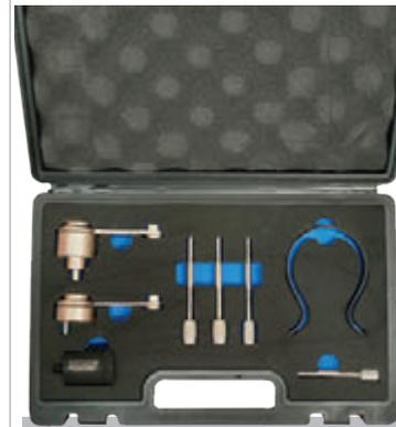
Conjunto de herramientas para el reglaje de los motores Jaguar Land Rover Diesel SDV6/TDV6 de 2.7 y 3.0.
