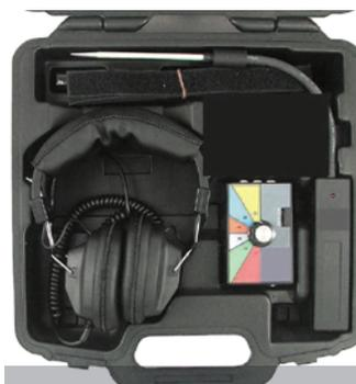
Ofrece la máxima sensibilidad al ruido con amplificador regulable de alta potencia. Incluye sonda de comprobación y 6 probadores con pinza y cable de 5 metros. El selector de pinza permite conmutar entre las 6 entradas, y permite comparar y detectar con facilidad problemas de mecánica en motor, transmisión, admisión, escape, inyectores, radiadores, válvulas y tanques de combustible. Auriculares grandes, ofrecen la máxima comodidad con cable de 2 metros
