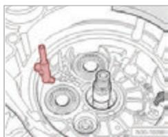
Permite la instalación y el arreglo de los embragues dobles sobre la transmisión DSG 6 velocidades de los vehículos del grupo VAG
