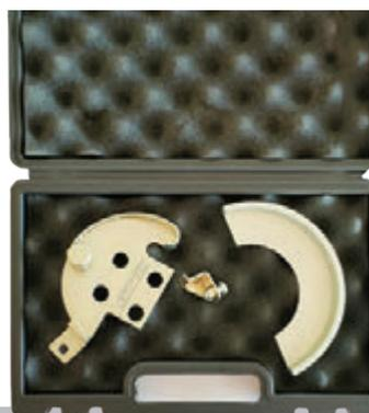
Juego de dos herramientas que facilita la instalación de la correa auxiliar cuando el ancho de la polea del cigüeñal restringe el acceso. Una pieza se pone en la polea de cigüeñal y la otra en la polea de la bomba de agua y usando un vaso de 17mm se rota para colocar la correa en las poleas.
