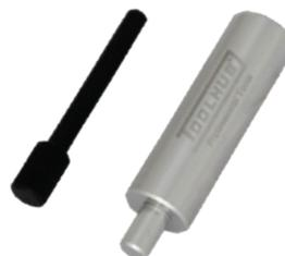
Juego de pasadores para bloquear la polea del árbol de levas en el motor DW10F 2.0 diésel. Se utilizan para mantener los arboles de levas alineados para poder desmontar la bomba de alta presión de diésel.
