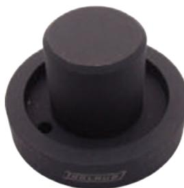
Útil que permite instalar el retén trasero de aceite de transmisión con presión uniforme para evitar dañar el retén.
