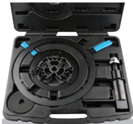
Esta herramienta es necesaria para resetear un embrague bimasa de las cajas de cambio de 6 velocidades DPS6 y DCT 250 de Ford.
