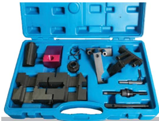
Conjunto de herramientas para los motores BMW M60 y M62, con y sin VANOS, utilizado en vehículos BMW y Range Rover.
