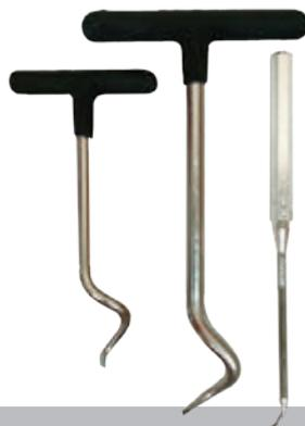
Conjunto de tres herramientas de taller diseñadas para extraer retenes y juntas sin causar daños en otros componentes.
