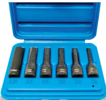
Vasos especiales que permitan romper el electrodo interno para dejar una superficie lo más plana posible y facilitar la perforación antes de la extracción del calentador.
