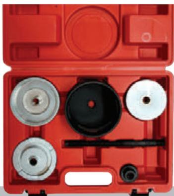
Herramienta de taller necesaria a la hora de llevar a cabo los procesos relacionados con la extracción e instalación de los silentblocks en el brazo de suspensión trasero. Diseñada especialmente para BMW X5
