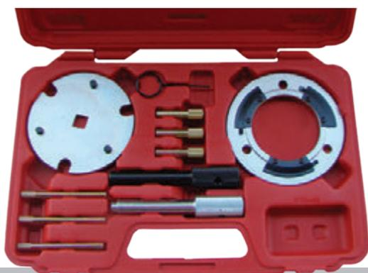
Este conjunto contiene los pasadores para asistir en el cambio de la correa o cadena de distribución de los motores Ford Duratorq 2.0, 2.2 y 2.4 y también los motores PSA/Ford 1.4 y 1.6 HDi. Adicionalmente incluyen las herramientas especiales para permitir quitar la bomba de alta presión diésel sin alterar el puesta a punto de la cadena de distribución.
